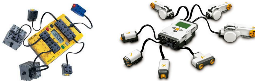
Figura 2.2.3. Detalhes dos kits (a) RCX e (b) NXT, apresentando o controlador conectado a seus sensores e motores.
